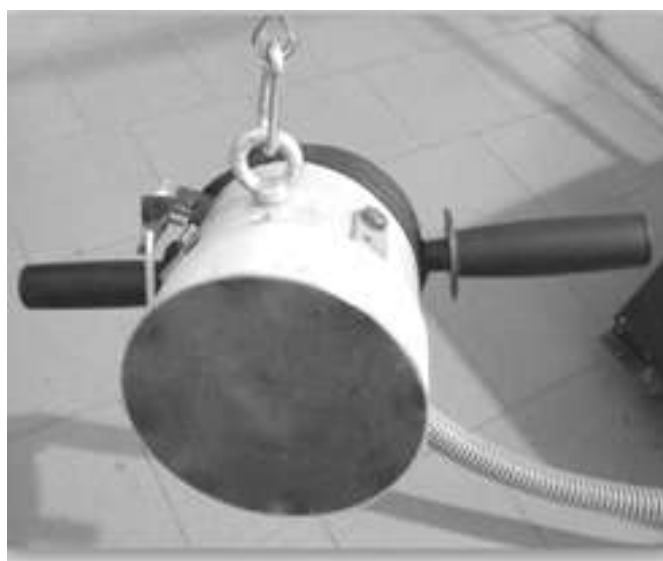
Рис. 3.2. Экспериментальная конструкция «индукторной системы с притягивающим экраном»: а – схематическое изображение; б – реальное воплощение
