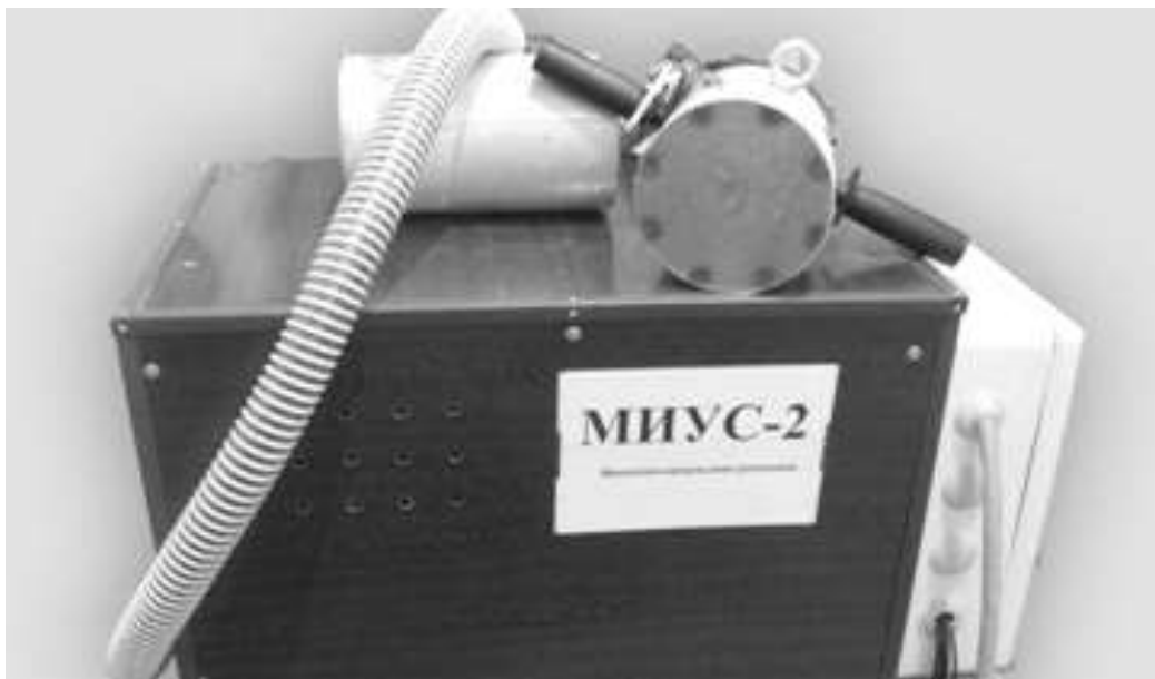
Рис. 3.3. Общий вид: магнитно-импульсная установка МИУС–2 с инструментом рихтовки
