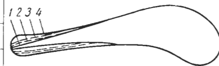
Рис. 75. Профиль с разной толщиной выходной кромки:
