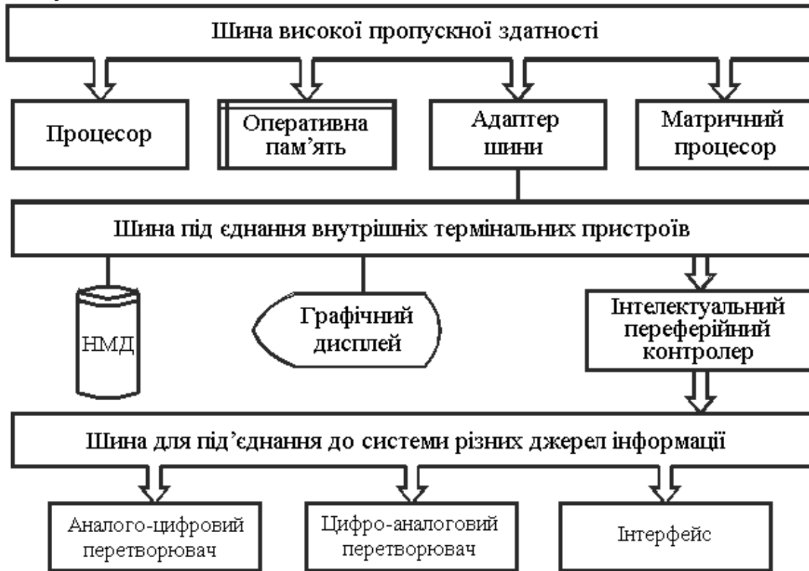
Рис. 10.5. Схема автономного термінального комплексу
