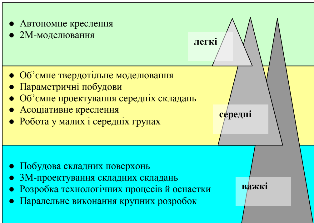
Рис. 9.1. Класи CAD/CAM-систем і обсяги виконуваних функцій
