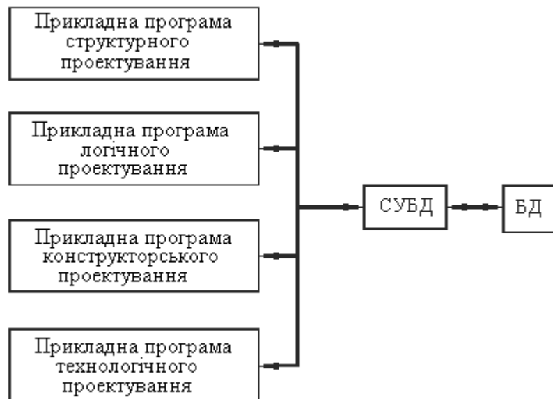
Рис. 6.2. Приклад використання СУБД і БД для проектування
