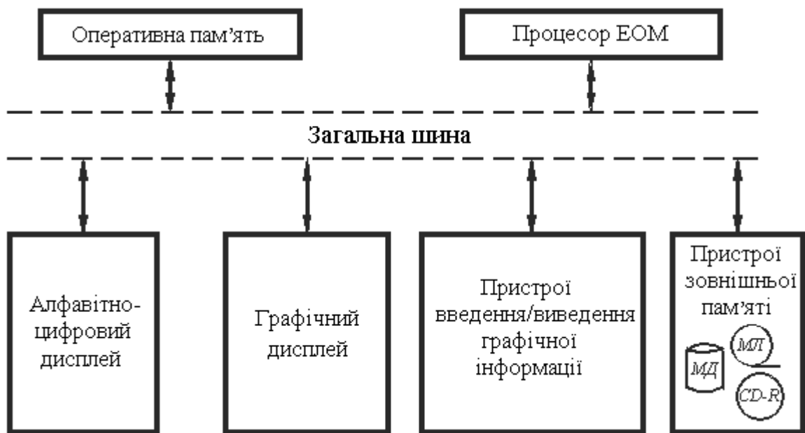
Рис. 5.5. Структурна схема АРМ
