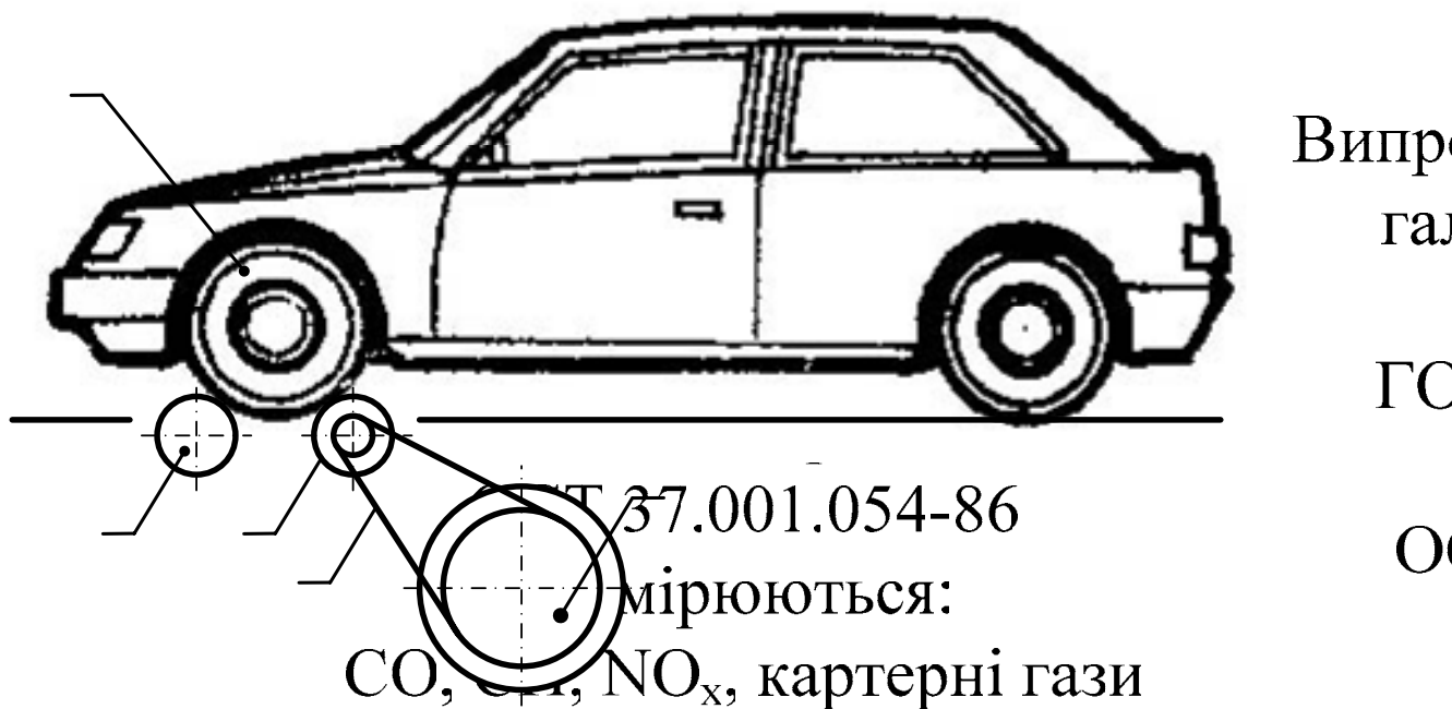
Рисунок 5.3 – Принципова схема станда з біговими барабанами: 1 – ведуче колесо; 2 – бігові барабани; 3 – маховик; 4 – привід маховика.
