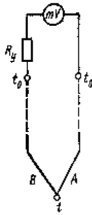
Рисунок 9.4 - Схема з'єднання мілівольтметра з термопарою
