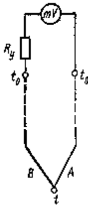
Рисунок 9.4 - Схема з'єднання мілівольтметра з термопарою
