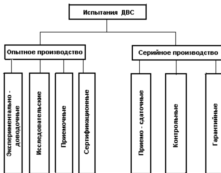
Рисунок 1.1 – Класифікація випробувань ДВЗ
