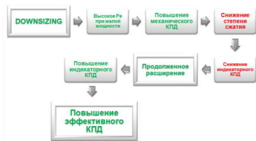
Рис. 3.9. Схема повышения топливной экономичности варианта двигатель-эспандер
