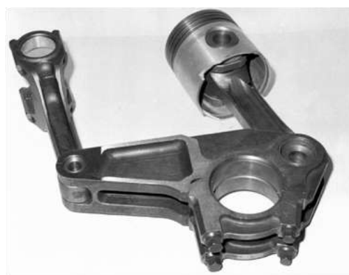
Рис. 5.3. Траверсный дизель Т-01 ( iV_h = 9,1 л) и его детали движения на базе двигателя ЯМЗ-8424
