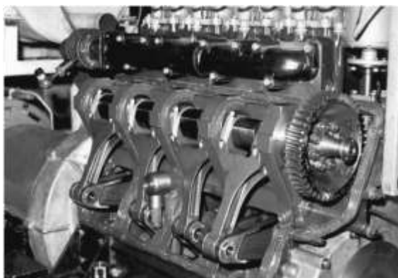
Рис. 5.3. Траверсный дизель Т-01 ( iV_h = 9,1 л) и его детали движения на базе двигателя ЯМЗ-8424
