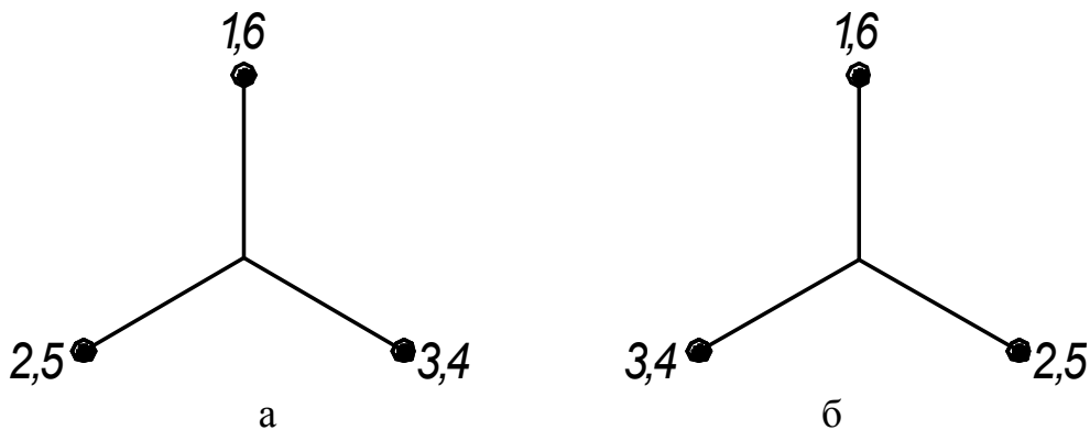
Рисунок 15.1 – Схеми колінчастих валів рядних шестициліндрових чотиритактних двигунів, що мають найкращу зрівноваженість
