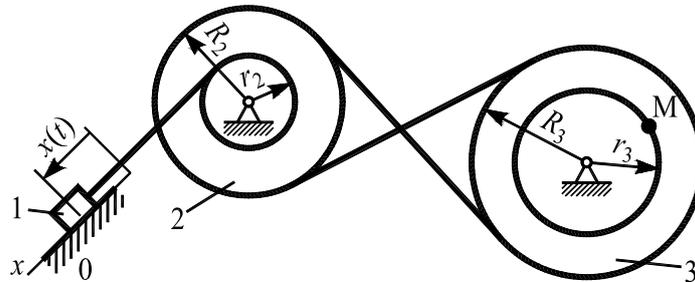
Рисунок К-1.2 – Схема механической системы
