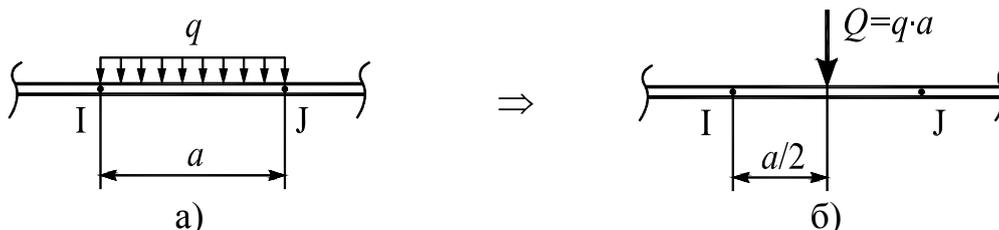
Рисунок С-1.8 – Замена погонной нагрузки равнодействующей
