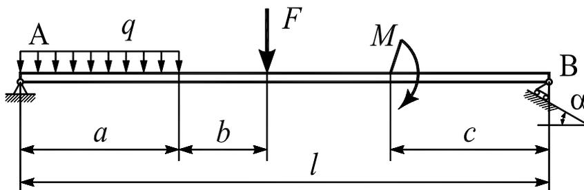
Рисунок С-1.9 – Схема нагружения балки
