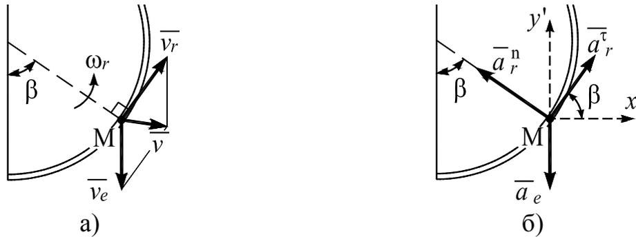
Рисунок К-2.4 – К определению абсолютной скорости и абсолютного ускорения точки М
