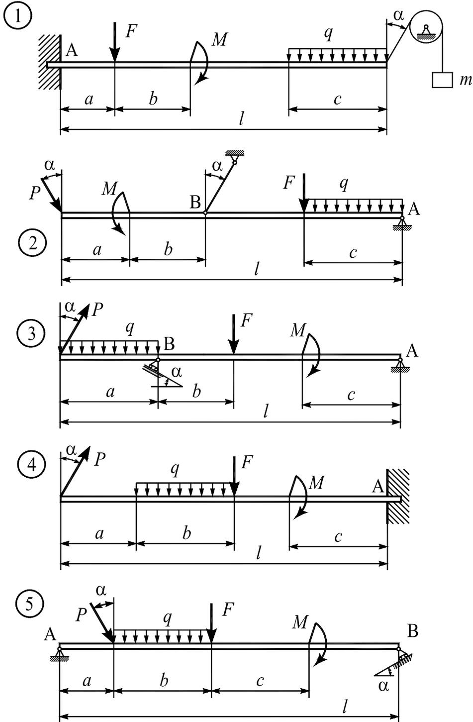
Рисунок С-1.1 – Схемы нагружения балок (начало)
