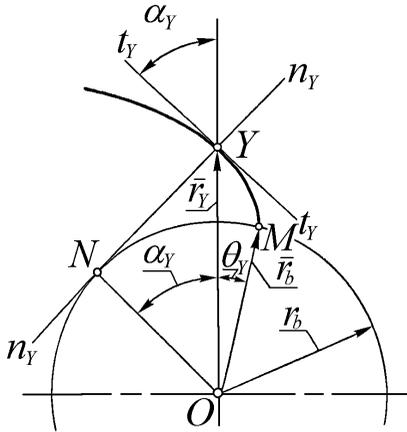
Рис. 4.3. До виводу рівняння евольвенти в полярних координатах
