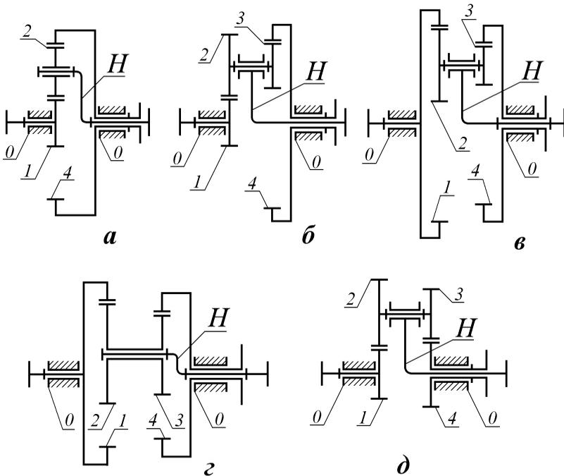
Рис. 3.17. Схеми найпростіших планетарних зубчастих механізмів
