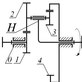
Рис. 3.20. Схема двоступінчастого прискорювача Джемса (з двовіничним сателітом)
