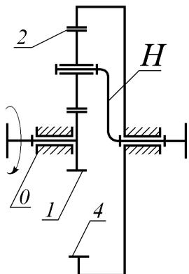
Рис. 3.19. Схема редуктора Джемса з одновіничним сателітом
