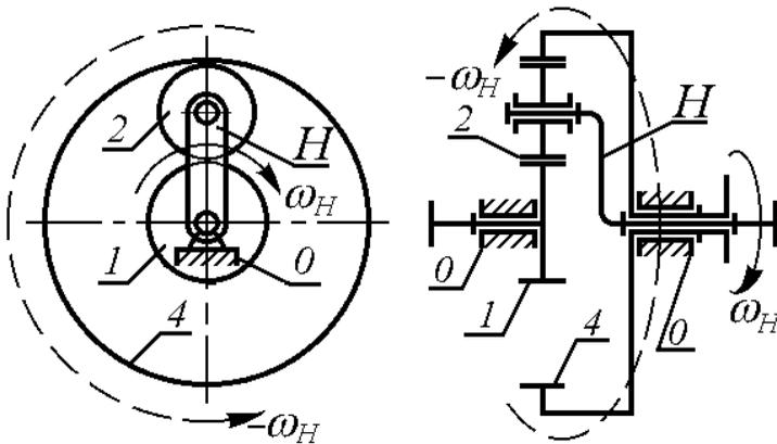
Рис. 3.18. Кінематична схема одноступінчастого планетарного механізму (планетарного механізму Джемса з одновінічним сателітом)
