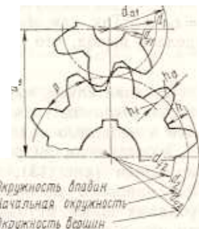
Рис. 12. Элементы зубчатого зацепления
