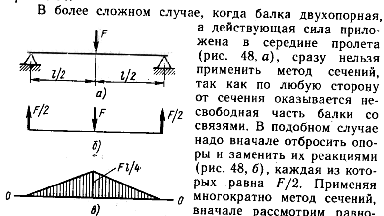
Рис. 48. Построение эпюры изгибающих моментов для двухопорной балки:
