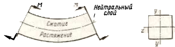
Рис. 43. Схема деформации при чистом изгибе
