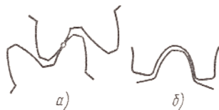
Рис. 16. Зацепление зубчатых колес с эвольвентным (а) и круговым (б) профилями зубьев
