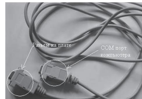
Рисунок 6 — Внешний вид кабеля COM порта
