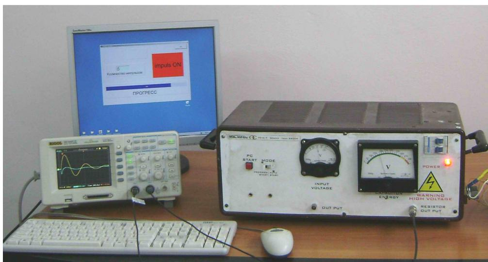
Рис. 2 Комплекс для имитации и моделирования процессов в инструментах магнитно-импульсной обработки металлов «малыш».
