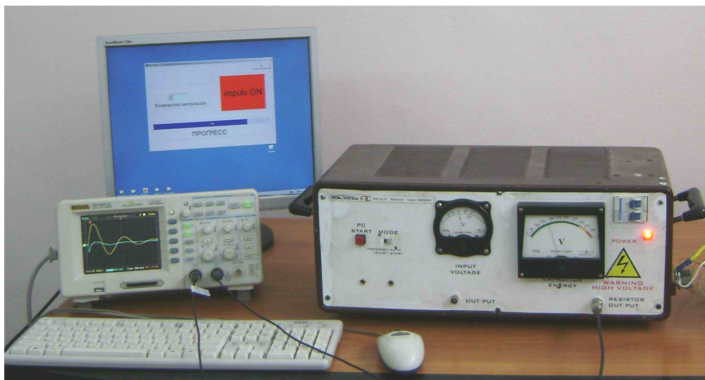
Рис. 3. Комплекс для имитации и моделирования процессов в инструментах магнитно-импульсной обработки металлов «МАЛЫШ»
