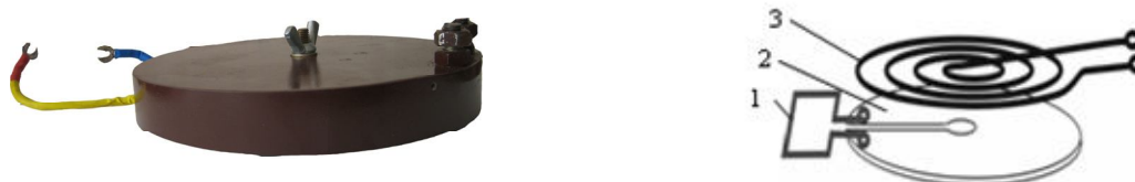
Рис. 6. Внешний вид и схематическое изображение СУ с плоским вторичным витком, имеющим радиальный разрез: 1 – нагрузка (исследуемая индукторная система); 2 – вторичная обмотка СУ; 3 – первичная обмотка СУ
