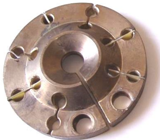
Рис. 7. Внешний вид индуктора с рабочей областью конического профиля
