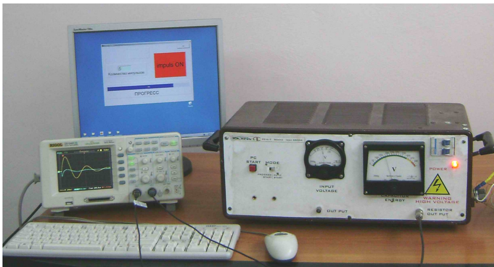
Рис. 1. Комплекс для имитации и моделирования процессов в инструментах магнитно-импульсной обработки металлов «МАЛЫШ»
