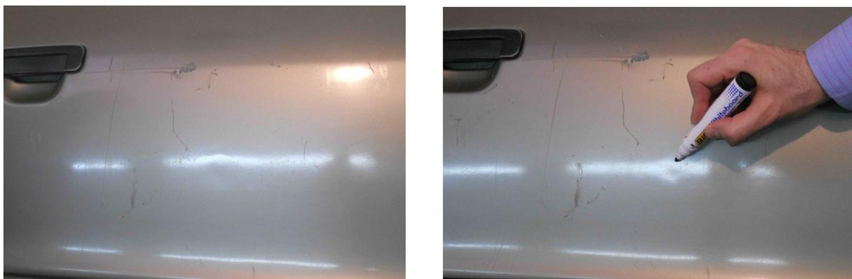
Рис. 13.8. Панель двери автомобиля Ауди с небольшой вмятиной
