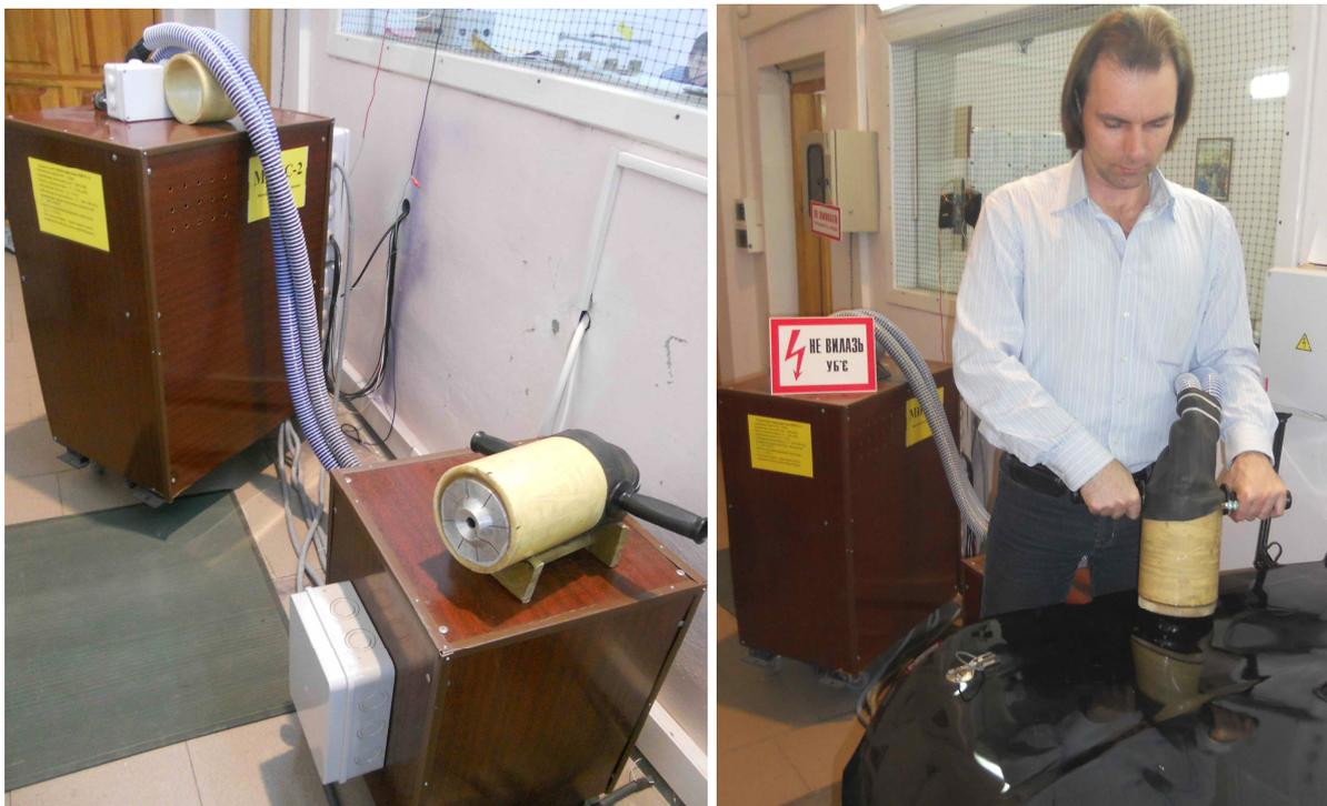
Рис. 13.12. Экспериментальный комплекс бесконтактной магнитно-импульсной рихтовки
