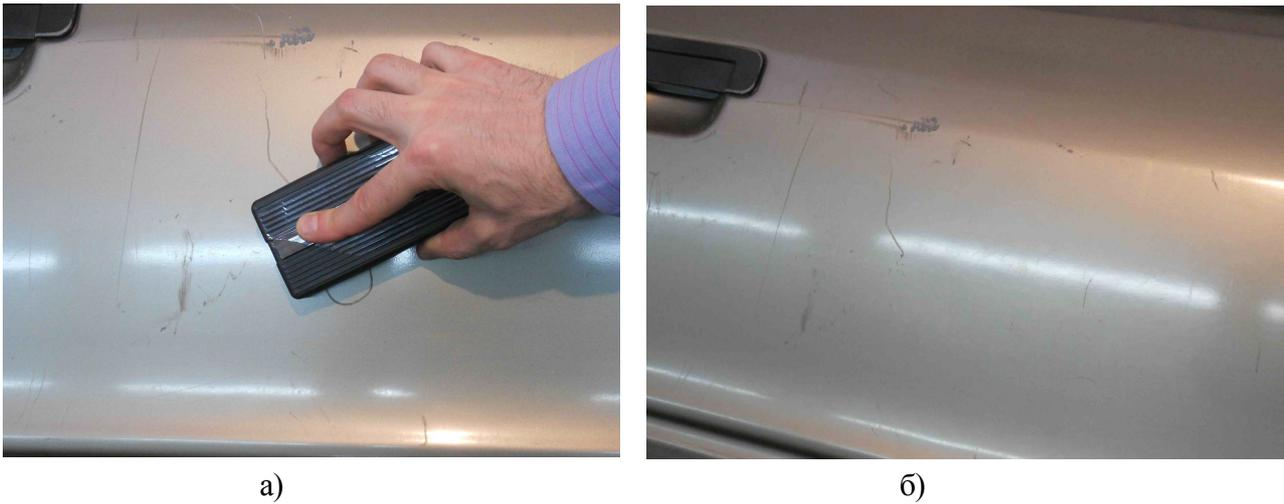
Рис. 13.11. Окончание процесса магнитно-импульсной рихтовки: а) удаление маркерных обозначений; б) элемент кузова автомобиля после рихтовки
