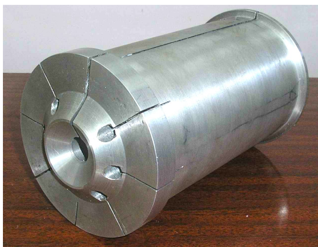
Рис. 14.12. Совмещенное цилиндрическое согласующее устройство: а) чертеж; б) физическая реализация
