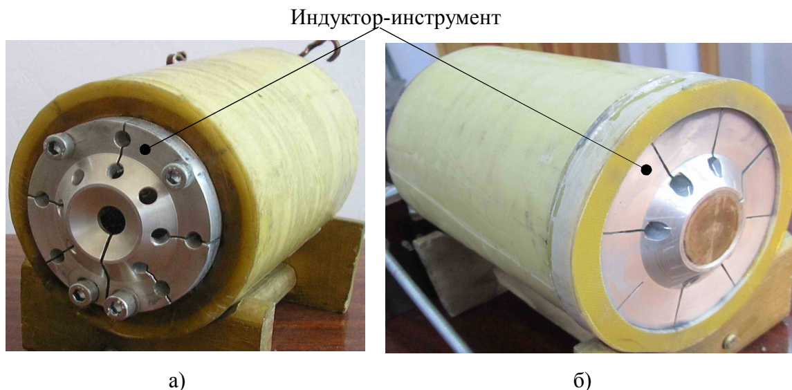
Рис. 14.11. Согласующее устройство цилиндрического типа: а) с одним вторичным разомкнутым витком, и подсоединенным к нему индуктором-инструментом; б) совмещенное
