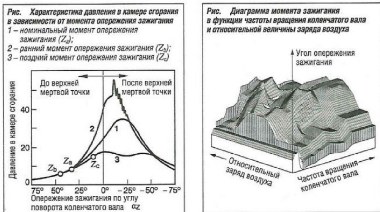
Рис.1 Характеристика тиску в камері згорання в залежності від моменту випередження запалювання і діаграма моменту запалювання в функції частоти обертання колінчастого вала і відносної величини заряду паливо-повітряної суміші.
