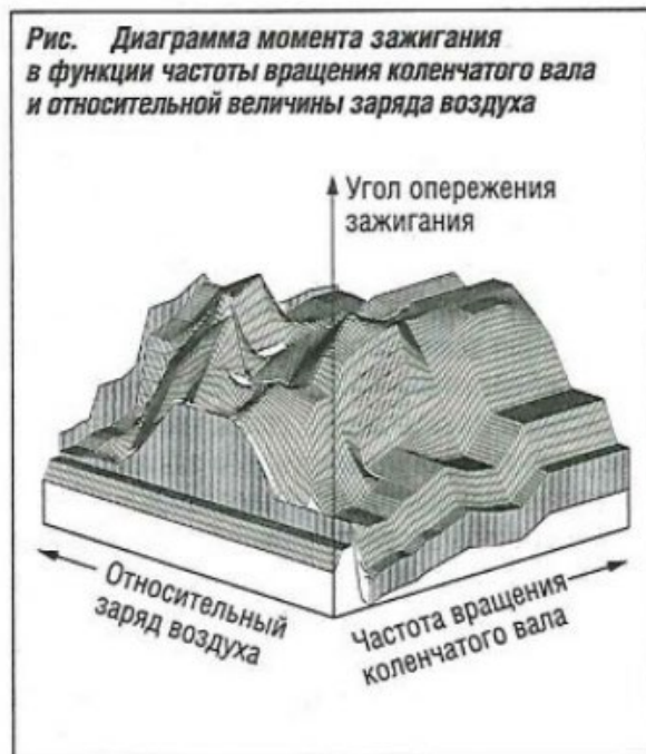
Рис.1. Характеристика давления в камере сгорания в зависимости от момента опережения зажигания и диаграмма момента зажигания в функции частоты вращения коленчатого вала и относительной величины заряда топливовоздушной смеси
