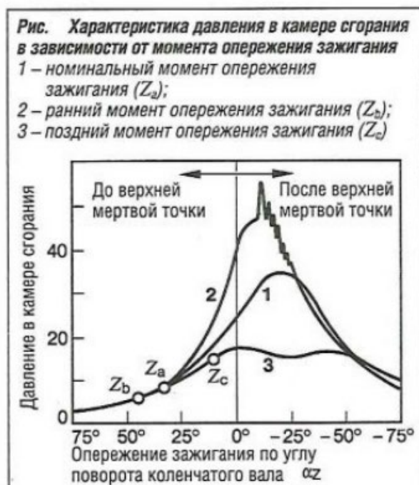
Рис.1. Характеристика давления в камере сгорания в зависимости от момента опережения зажигания и диаграмма момента зажигания в функции частоты вращения коленчатого вала и относительной величины заряда топливовоздушной смеси
