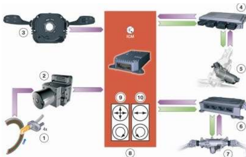
1 – датчик кутової швидкості коліс; 2 – модуль системи DSC; 3 – датчик кута повороту керма; 4 – блок керування AL; 5 – виконавчий механізм AL; 6 – блок керування HSR; 7 – виконавчий механізм HSR; 8 – блок керування ICM; 9, 10 – датчики DSC
