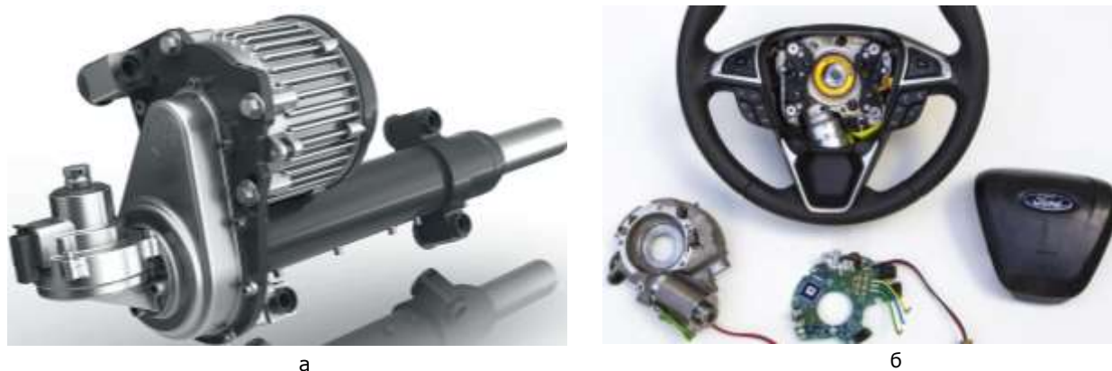
а – на рульовому механізмі ReAX EPS; б – на ступці керма Рисунок 23. Компонівка електричного приводу керма
