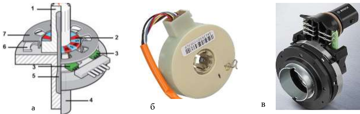
а – устрій; б, в – конструктивні виконання Рисунок 5. Датчики крутного моменту
