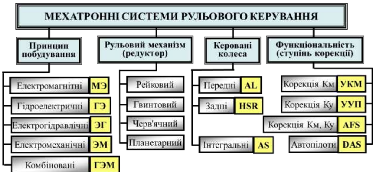
Рисунок 2. Класифікаційна структура мехатронних систем рульового керування
