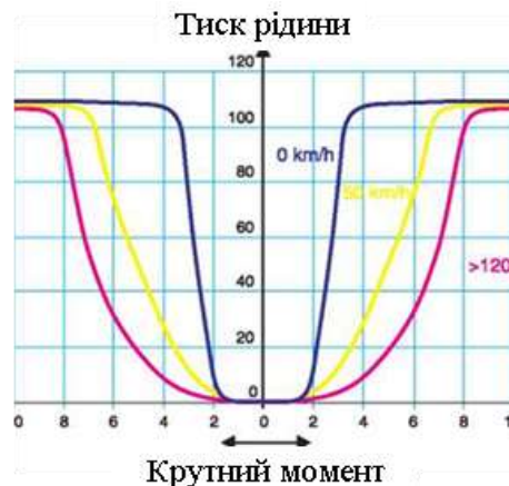
Рисунок 4. Регульовальні характеристики підсилювача рульового керування
