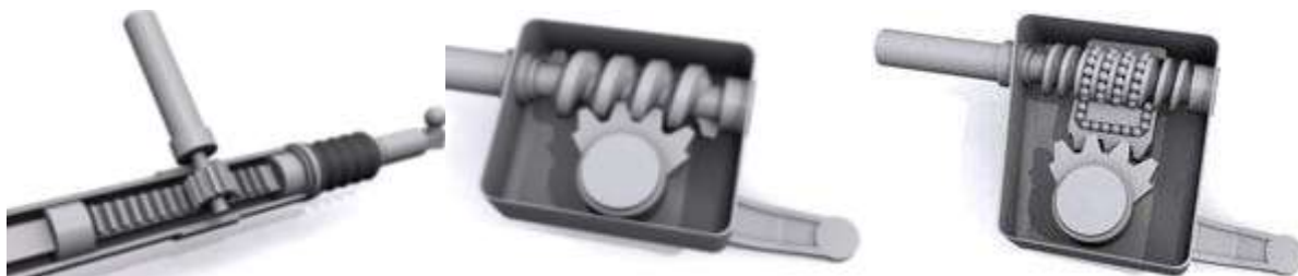
а – рейка; б – черв'як; в – кулькова гайка
