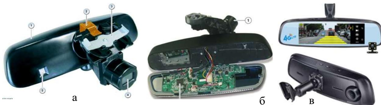
а, б – с камерой во внутреннем зеркале заднего вида; в – с автономной камерой
