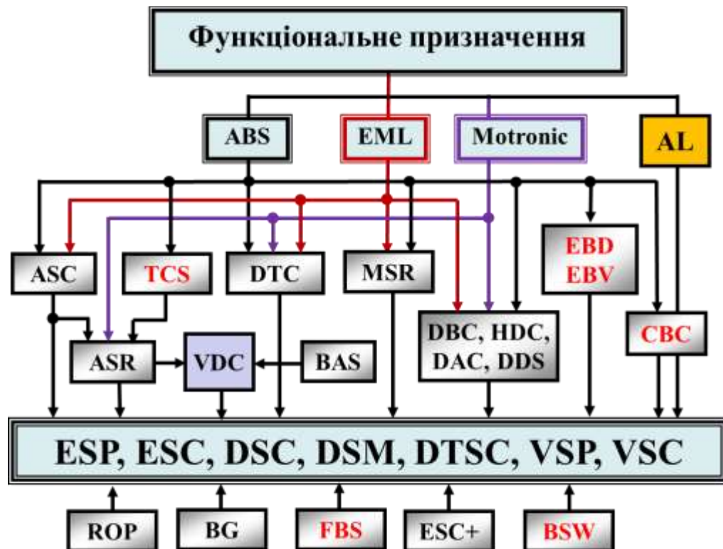
Рис. 3. Классификационная структура комбинированных систем управления
