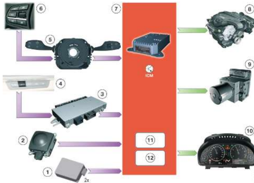
Рис. 12. Системы помощи водителю, влияющие на продольную динамику: 1 – радар ближнего действия SRR; 2 – радар дальнего действия LRR; 3 – модуль в пространстве для ног; 4 – панель управления функциями помощи водителю; 5 – коммутационный центр в рулевой колонке; 6 – панель управления DCC или клавиши ACC Stop & Go на рулевом колесе; 7 – интегрированная система управления ходовой частью; 8 – двигатель и трансмиссия; 9 – система динамического контроля стабильности; 10 – комбинация приборов; 11 – функция DCC; 12 – функции ACC Stop & Go и адаптивный тормозной ассистент
