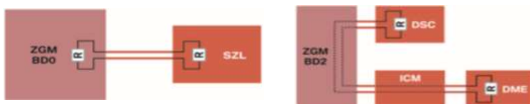
Рис. 10. Способы подключения по шине FlexRay: а – тупиковый; б – сквозной
