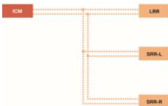
Рис. 15. Пример структуры под-шины Local-CAN:
