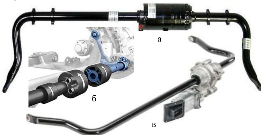
Рис. 1. Активные стабилизаторы поперечной устойчивости: а, б – с гидроприводом; в – с электроприводом
