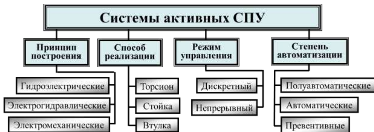
Рис. 2. Классификационная структура активных систем СПУ
