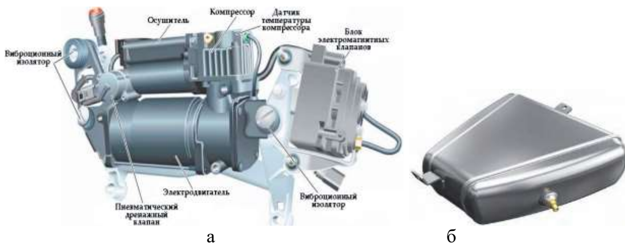
Рис. 12. Компоненты пневмосистемы: а – модуль подачи воздуха; б – ресивер
