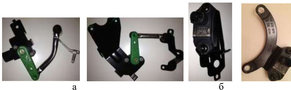
Рис. 18. Датчики подвески: а – дорожного просвета; б – ускорения кузова
