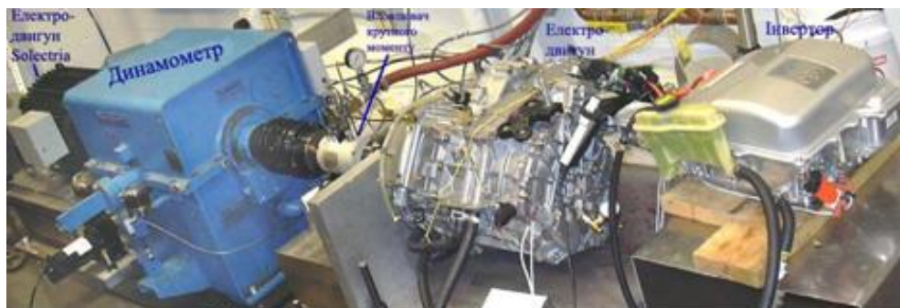
Рисунок 2.3 – Лабораторна установка для дослідження робочих характеристик
