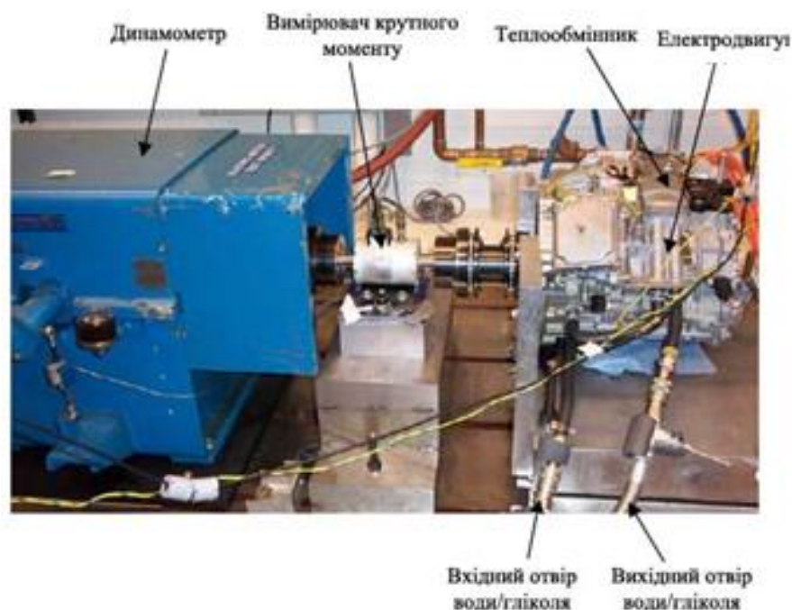
Рисунок 3.3 – З'єднання валів у лабораторній установці
