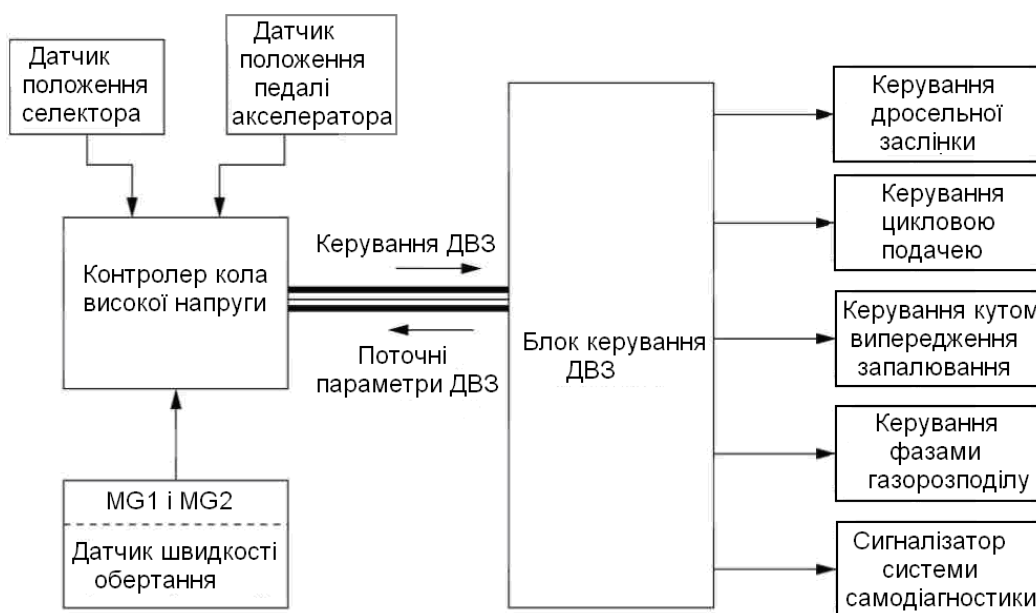
Рисунок 1.3 – Схема структурна системи керування ДВЗ
