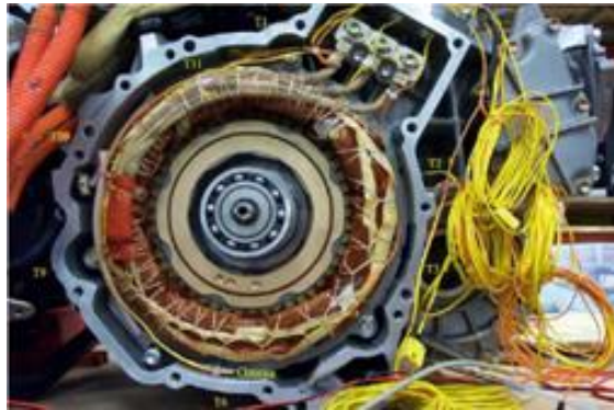
Рисунок 3.1 – Місця розташування термопари в електродвигуні
