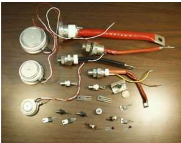
Тиристоры являются наиболее мощными электронными ключами, способными коммутировать цепи с напряжением до 5 кВ и токами до 5 кА при частоте не более 1 кГц.
