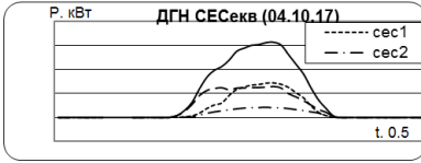
Рисунок 2 – Побудова ДГН екв приватних СЕС: СЕС1, P вст = 20 кВт; СЕС2 – 5,2 кВт; СЕС3 – 30 кВт
