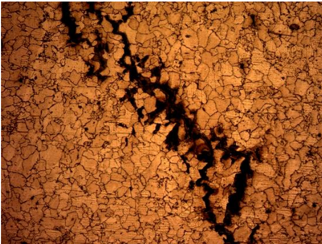
Рисунок 1 – Міжзеренний характер тріщини повзучості, що розвивається по крихкому механізму в ЗТВ. Зварне з'єднання зі сталі 12Х1М1Ф. Напрацювання 290000 год. \times 200
