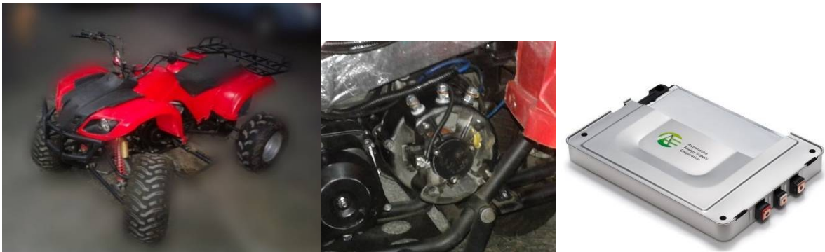
Рисунок 1 – Електроквадроцикл, вентильний двигун та літєва батарея
