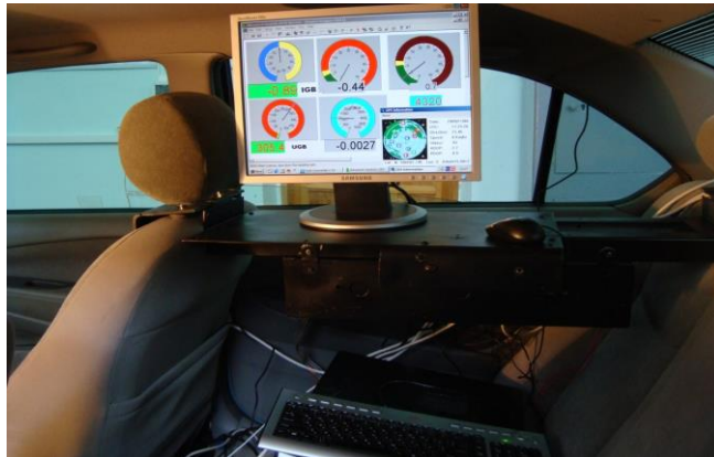
Рисунок 3 – Вимірювальний комплекс на автомобілі
