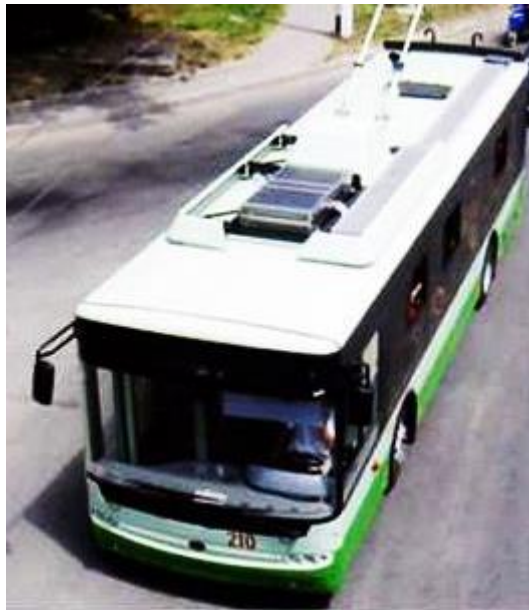
Рисунок 1 – Розташування обладнання на даху тролейбуса БОГДАН Т 601.10
