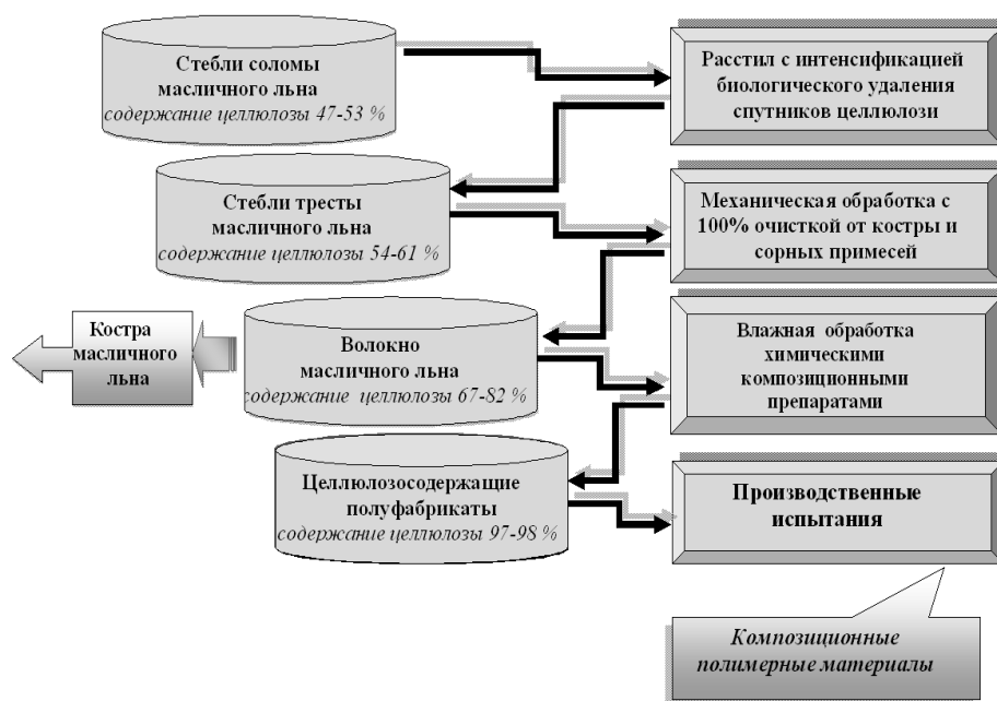
Рисунок 1. Технологическая схема углубленной очистки стеблей соломы масличного льна
