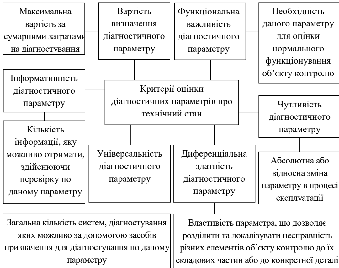
Рисунок 1 – Блок-схема формування критеріїв оцінки раціональних діагностичних параметрів
