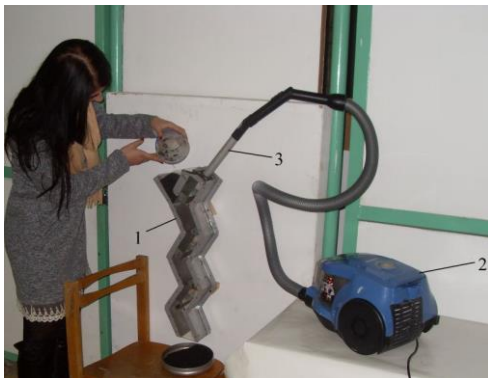
Рисунок 3 - Дослідна установка для пневмокласифікації: 1 – пневмокласифікатор типу «Зиг-заг»; 2 – пиломок; 3 – трубопровід
