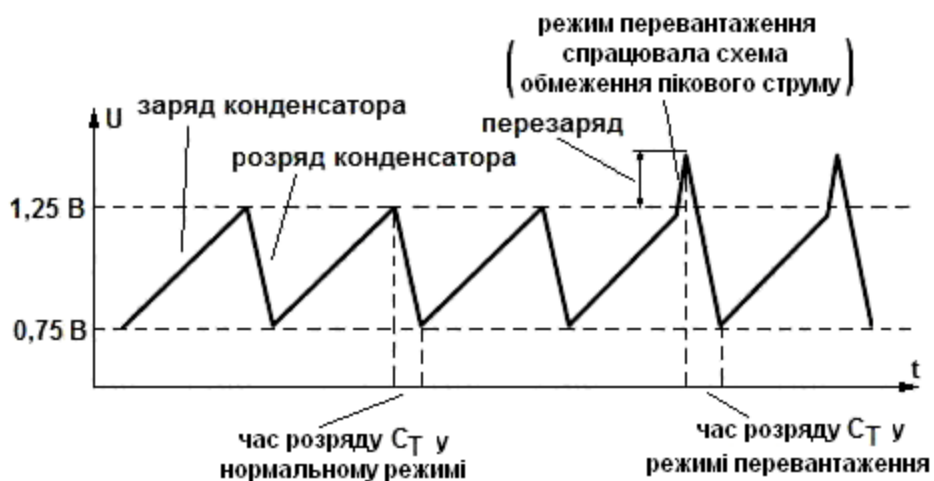
Рисунок 2 - Осцилограма роботи схеми обмеження струму
