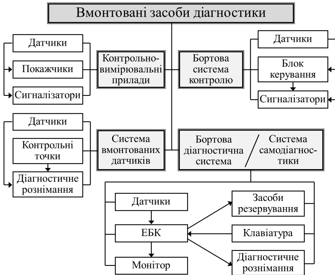
Рис. 2.3.17. Класифікаційна структура вмонтованих засобів діагностики автомобіля
