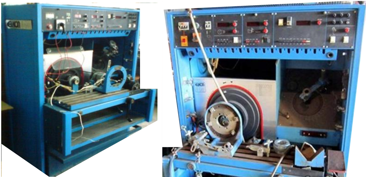
Рис. 2.3.14. Універсальний стенд комплексних перевірок елементів систем електрообладнання типу Elkon U 400
