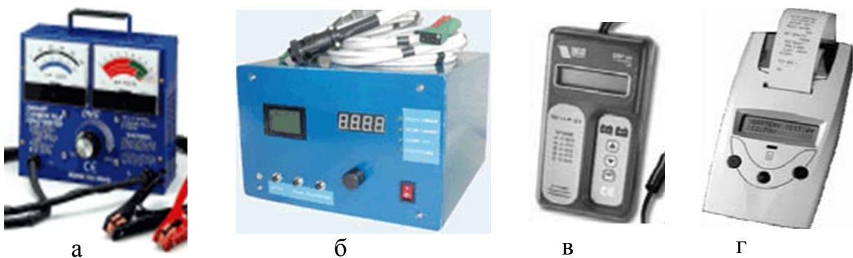
Рис. 2.3.16. Зовнішній вигляд тестерів АКБ: а – аналоговий переносний; б – цифровий настільний; в – цифровий портативний; г – цифровий з принтером
