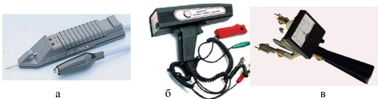
Рис. 2.3.2. Зовнішній вигляд переносних діагностичних приладів: а – логічний пробник (індикатор); б – стробоскоп; в – навантажувальна вилка
