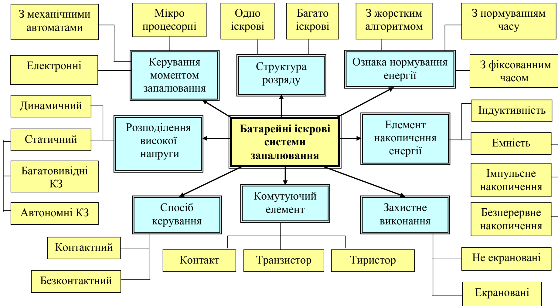
Рис. 4.1.3 Класифікація систем запалювання за загальними ознаками
