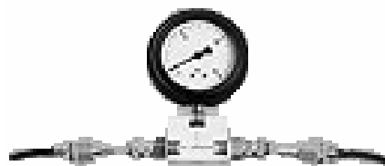
Тестер пезоінжекторів Common Rail
