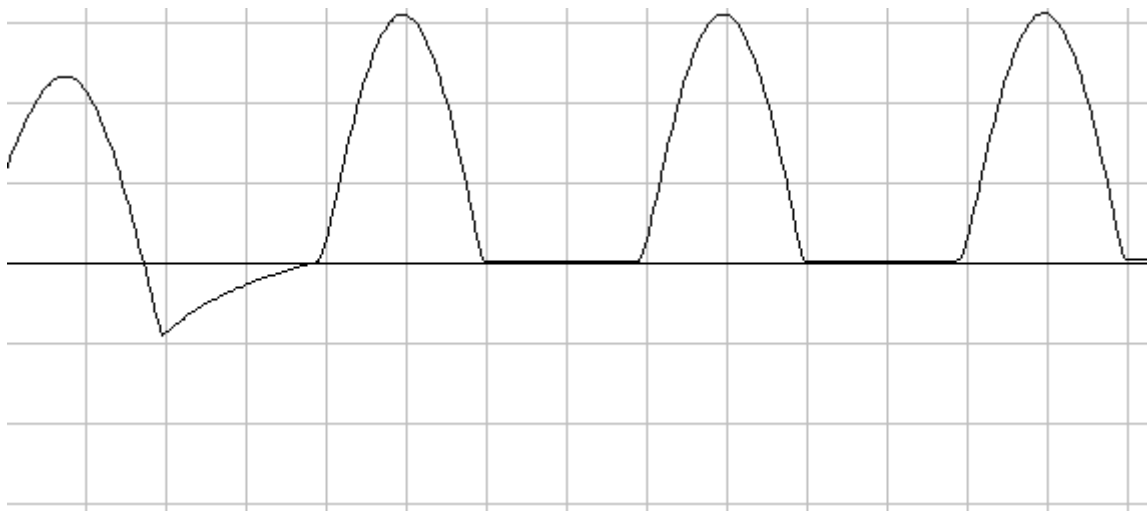
Рисунок 11.3 – Осцилограма вихідної напруги випрямляча при фіксованому опорі R_H=1 кОм, без конденсатора C_\Phi .
