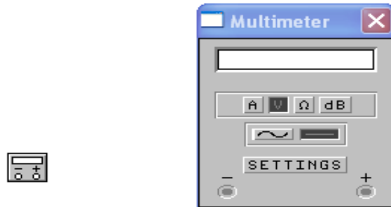
а) б) Рисунок 9.2. Умовне позначення (а) і загальний вигляд (б) мультиметра
