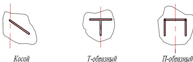
Рис. 8.3. Виды технологических разрезов юбки поршня
