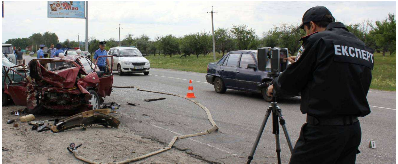
Рисунок 5.2 – Лазерне сканування місця ДТП
