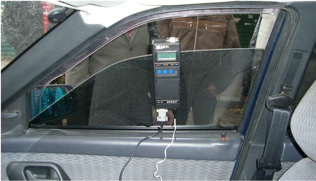
Рисунок Ж.2 – Установка электронного блока приладу «Ефект» на скло
