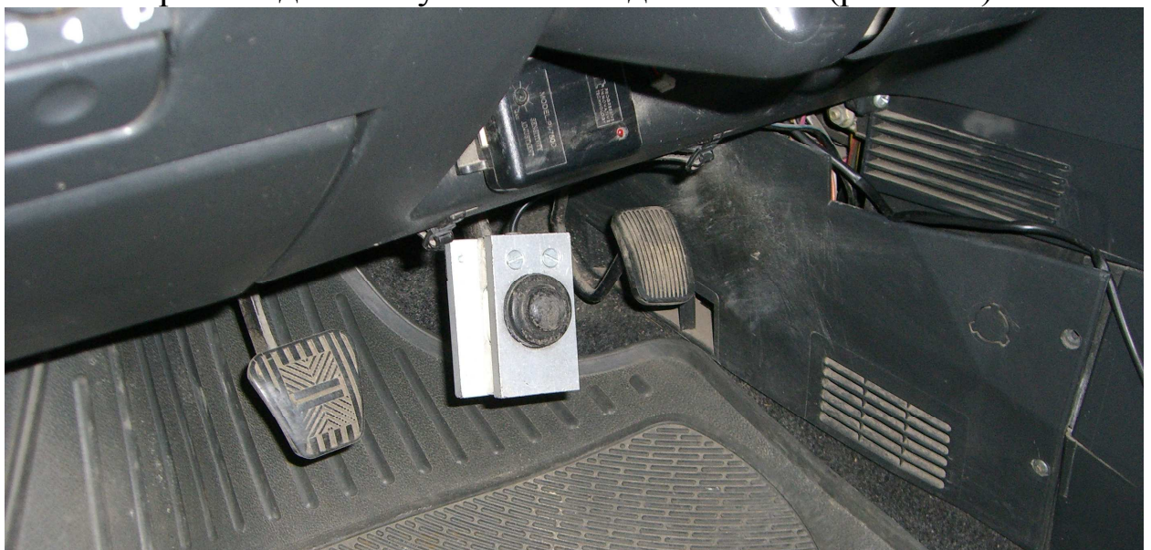
Рисунок Ж.3 – Установка датчика зусилля на педалі гальма
