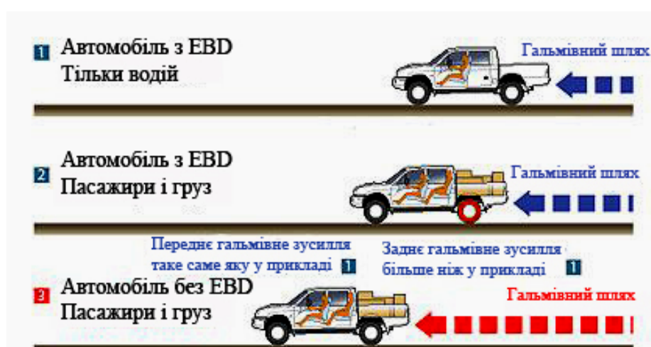
Рисунок 1.24 – Ефективність гальмування автомобіля з системою EBD та без неї
