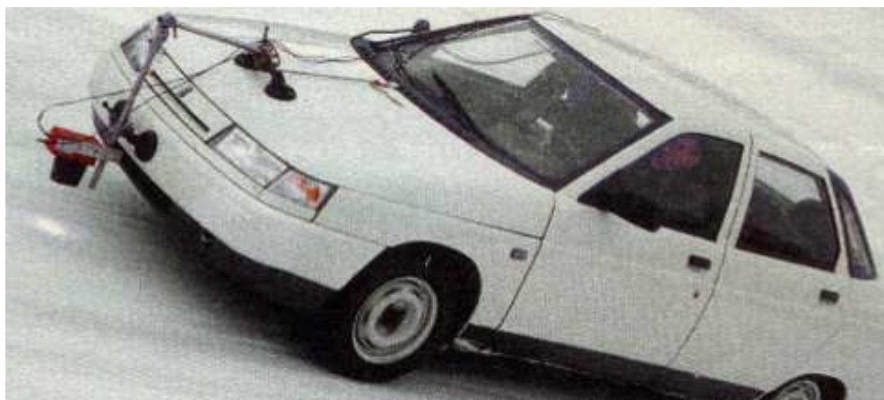
Рисунок 2.4 – Оптичний комплекс фірми «Datron» для вимірювання гальмівної динаміки автомобіля
