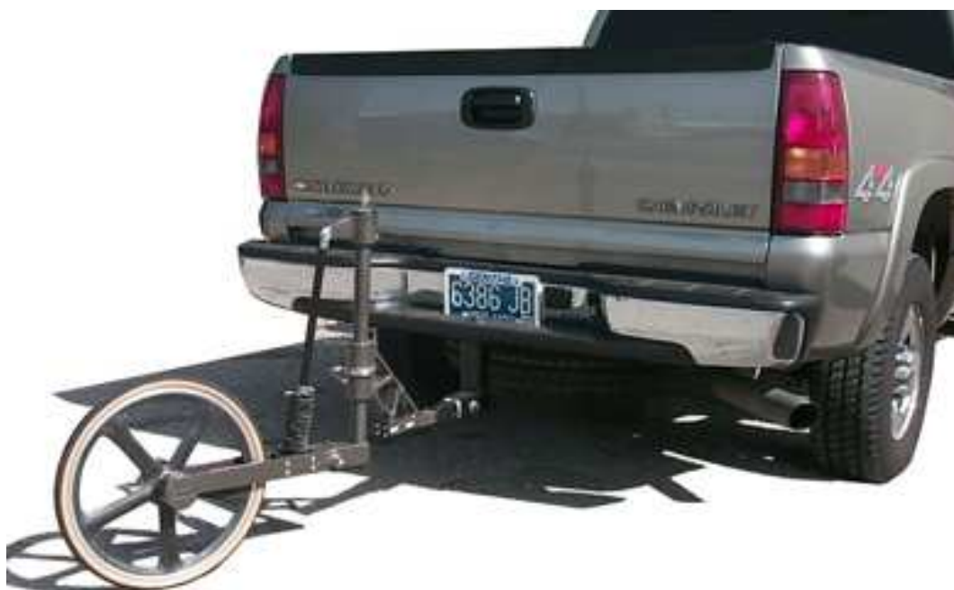
Рисунок 2.3 – Прилад «п'яте колесо» для вимірювання гальмівного шляху ТЗ
