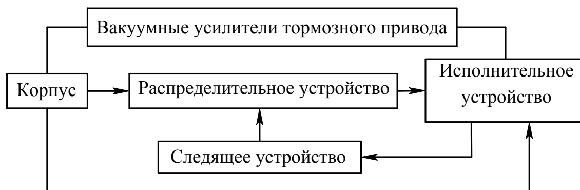
Рис. 1.21. Структура вакуумных усилителей тормозного привода
